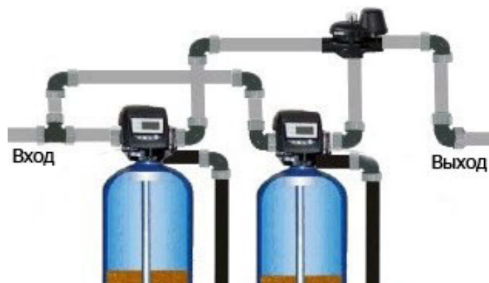
Схема подключения клапанов с корпусами 18'' – 36''
