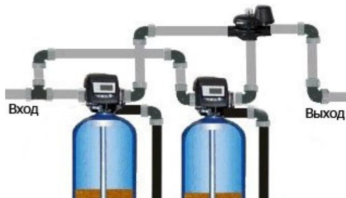
**Схема подключения клапанов
